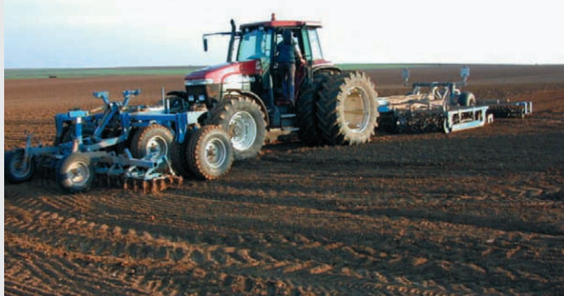
L'équipement complet jumelage et tasse-avant répartit les poids sur toute la largeur de travail et limite les risques de tassement.
