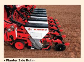
Roulette intermédiaire : En inox Mise en terre : Balancier avec soc. Recouvrement : Roues en V à bandage caoutchouc.
