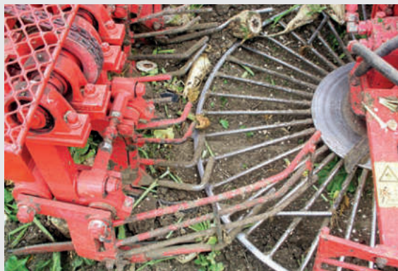
Turbine de reprise.
