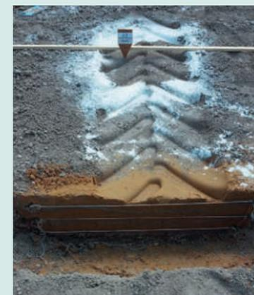
Michelin présentera des mini-fosses pédagogiques afin de montrer l'impact de la pression des pneumatiques sur le tassement de sol, à la fois sur une machine spécifique aux betteraves mais aussi sur une benne. Les couches de sol jusqu'à la semelle de labour sont reproduites avec deux colorations différentes afin de faciliter la lecture des visiteurs, qui pourront observer la différence de tassement uniquement sous l'angle de la pression des pneumatiques.
