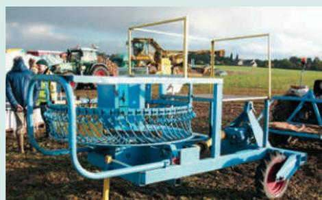
La turbine IRBAB est utilisée pour simuler différents niveaux de blessures des betteraves dans le cadre des essais de stockage.
