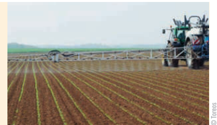
Pulvérisateur classique équipé de porte-buses Tereos pour la pulvérisation localisée.
