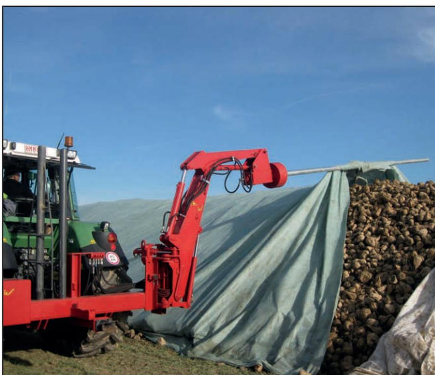
Le bâchage mécanique assure une pose rapide et efficace de la bâche Top Tex®.
