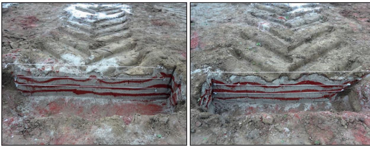
Comparaison de l'impact d'un passage de roue entre un pneu gonflé à 2,7 bar (à gauche) et un pneu gonflé à 1,7 bar (à droite).
