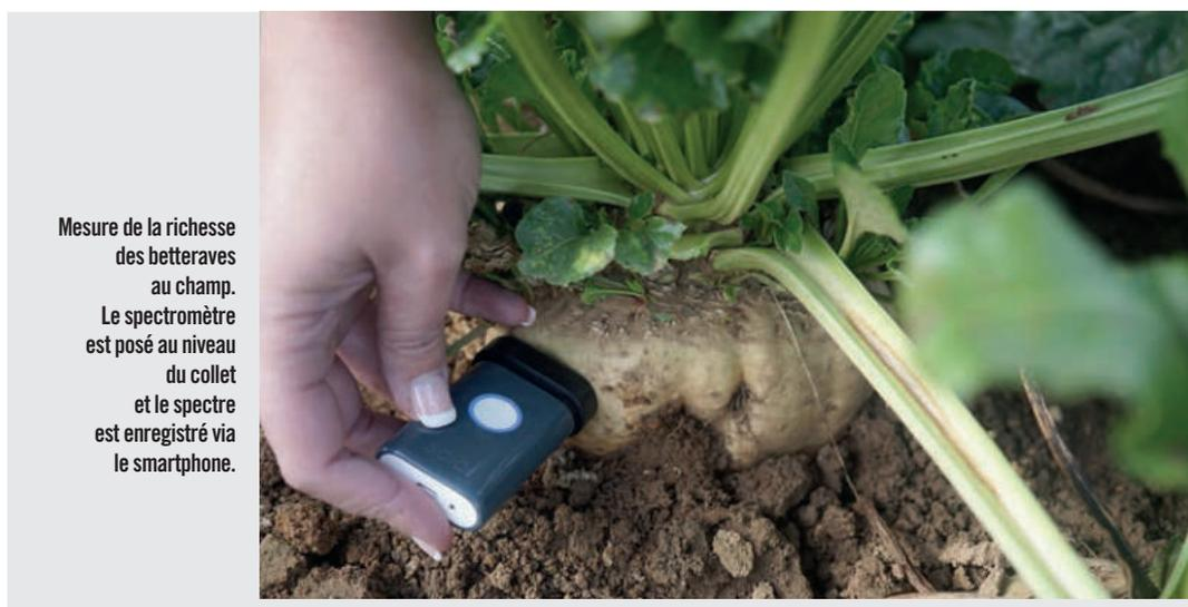
Mesure de la richesse des betteraves au champ. Le spectromètre est posé au niveau du collet et le spectre est enregistré via le smartphone.
