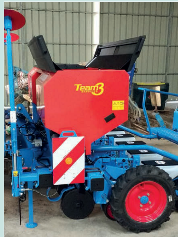
Semoir équipé d'un dispositif de localisation d'engrais solide.
