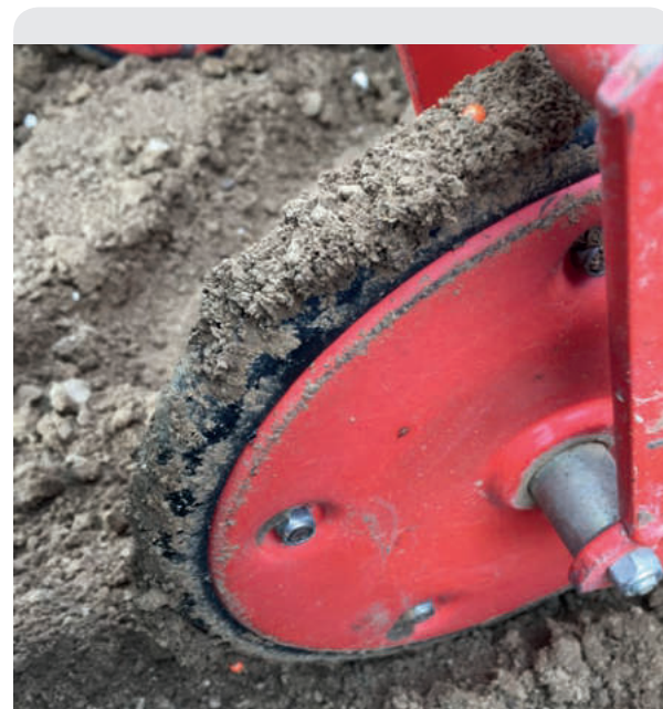
Si le semis est réalisé en conditions humides, relevez la roulette de plombage afin d'éviter de remonter les graines à la surface.
