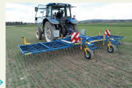
Les outils de désherbage mécanique sont mis en œuvre dès que possible dans les céréales, avec une herse étrille (blé et orge).
