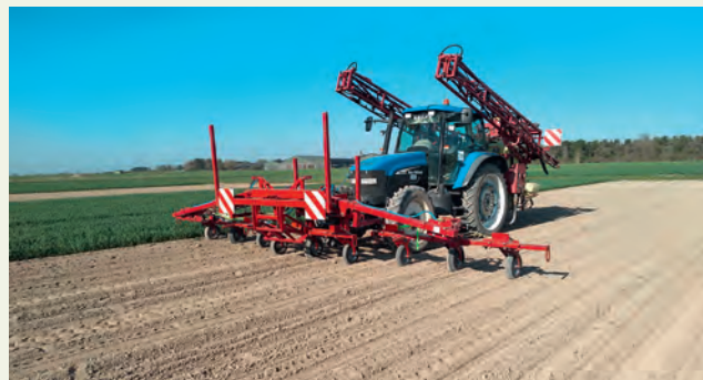
Le désherbage ou d'autres interventions peuvent être réalisés sur le rang avec une rampe de localisation (utilisée dans le système témoin sur la photo). Le traçage au sol après une implantation Strip Till est problématique, le guidage RTK est obligatoire.
